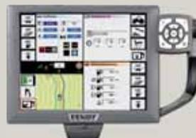
➔ El Fendt 500 Vario está equipado con un indicador de consumo de combustible. Además de monitorizar el actual consumo, registra el consumo de combustible para distintas operaciones. Esto ayuda al operador a una conducción eficiente.
