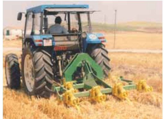
Figura 6. Labranza vertical que permite la pervivencia de gran parte del rastrojo.
