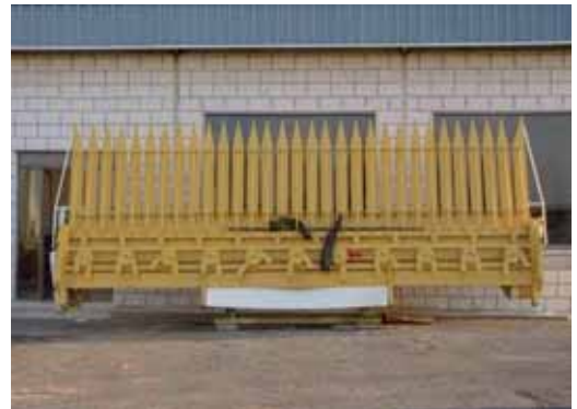
Figura 14. Sistema de picado de las cañas de girasol en el cabezal de la cosechadora.
