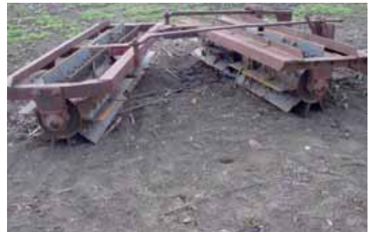
Figura 15. Apero para el derribo y picado de las cañas de girasol sin alterar el suelo.
