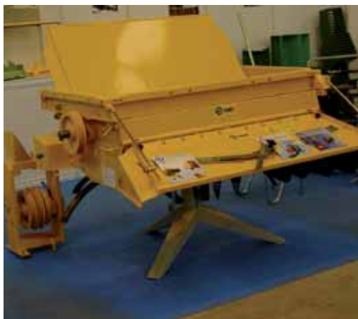
Figura 13. Sistema de esparcido de paja acoplable a cosechadora.
