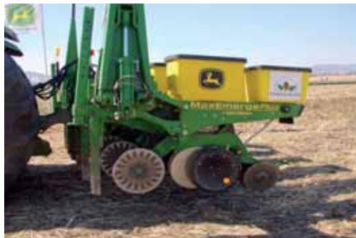
Figura 16. Sembradora directa de precisión con disco de corte de residuos, disco doble de apertura del surco de siembra, control de profundidad en cada cuerpo por rueda neumática y cierre del surco por dos ruedas en V.
