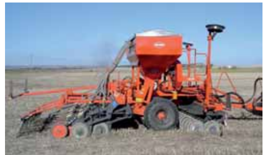
Figura 19. Sembradora directa de chorrillo con disco de corte de residuos delantero y apertura del surco con disco doble.
