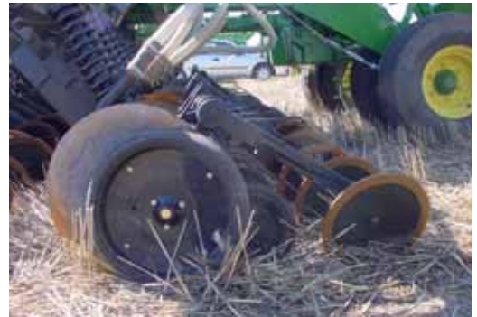
Figura 18. Sembradora directa de chorrillo de disco único, con rueda fijadora y cierre por rueda inclinada.
