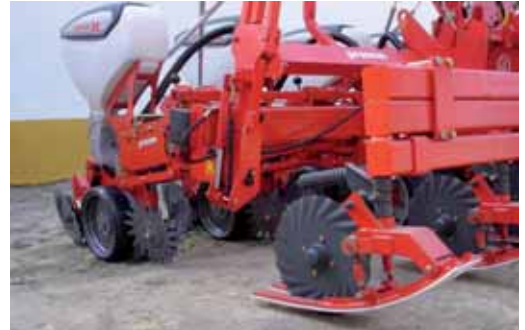
Figura 17. Sembradora directa de precisión con disco de corte de residuo con patín de control, ruedas de limpieza del surco y disco doble de apertura del surco de siembra.
