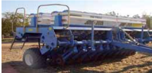
Figura 11. Sembradora directa con doble tolva para siembra y abonado localizado. No tiene disco de corte de rastrojo y dispone de disco doble de apertura del surco.
