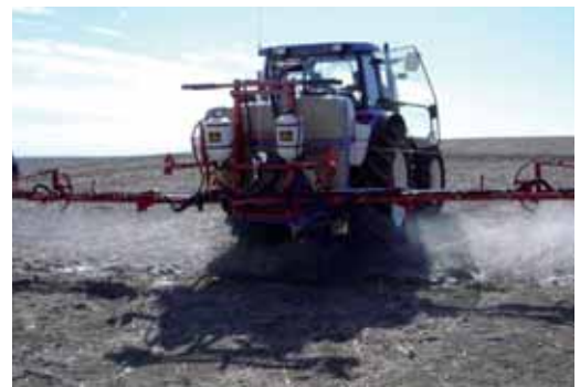
Figura 9. Barra de tratamientos con boquillas antideriva (izq.) y normales (derecha).
