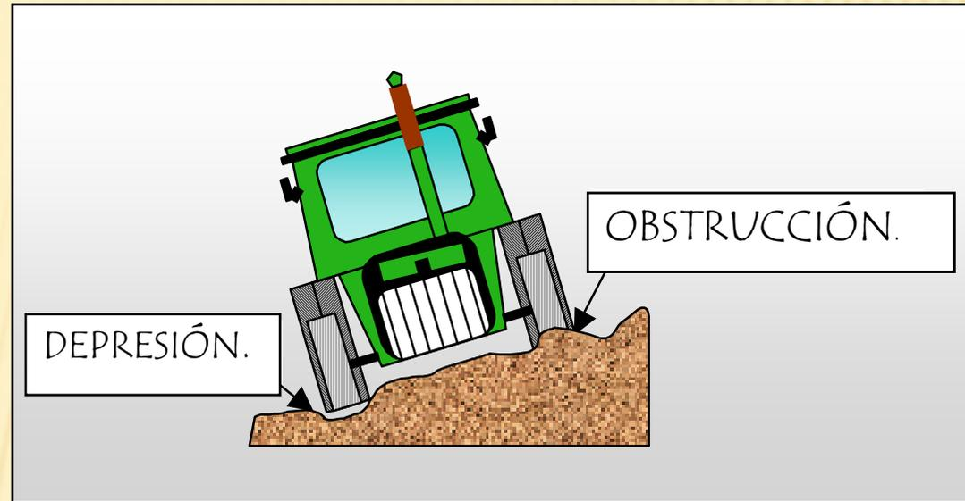
1º.- Situación simultánea sobre un terreno inclinado, de una "depresión" en una de las ruedas laterales y una "obstrucción" en las ruedas del lado opuesto.
