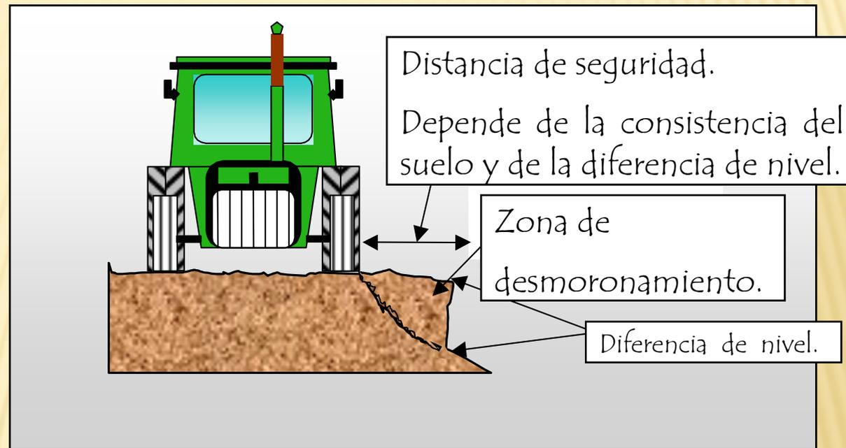
3º.- Insuficiente distancia de seguridad entre el tractor y zanjas, parcelas a distinto nivel, orillas de ríos, etc.
