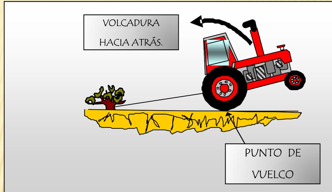
1º.- Cuando la resistencia del elemento a arrastrar, arrancar, etc exige una potencia tal que al tractor le es más fácil levantar las ruedas delanteras que girar las traseras.
